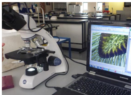
Dengys sgrin y cyfrifiadur lun o un o aelodau nofio cimwch a dynnwyd gan ddefnyddio camera microsgop USB ar gyfer ei ddadansoddi
